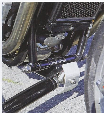
Feinarbeit: Ein graziler Hilfsrahmen trägt die Kugelgelenke für den Anschluss des Beiwagens.
