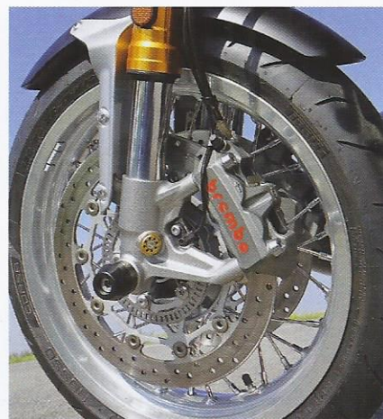
Veredelt: Radialbremszangen und schwimmend gelagerte Scheiben sind der Thruxton R vorbehalten.
