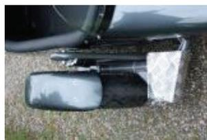
Das Deltabox-Chassis der Genesis erfordert einen vergleichsweise aufwändigen Hilfsrahmen, um die beiden Gelenklager zum Anschluss des Hunde-Beibootes Dog-Side entsprechend dem auch von Armec und Kalich realisierten Schwenker-Konzeptes zu plazieren. Zum Lieferumfang gehören die Pulverbeschichtung aller Stahlkomponenten in diversen Farbtönen, Hohlraumversiegelung für das Boots-Chassis, Edelstahlschrauben und -verbindungselemente, Kombistecker für die Beiwagen-Elektrik.
