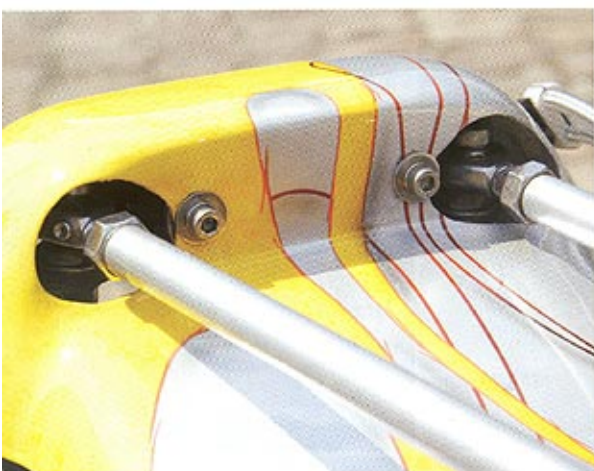
GUT GESCHÜTZT: Massive Kugelgelenke der Achsschenkellenkung
