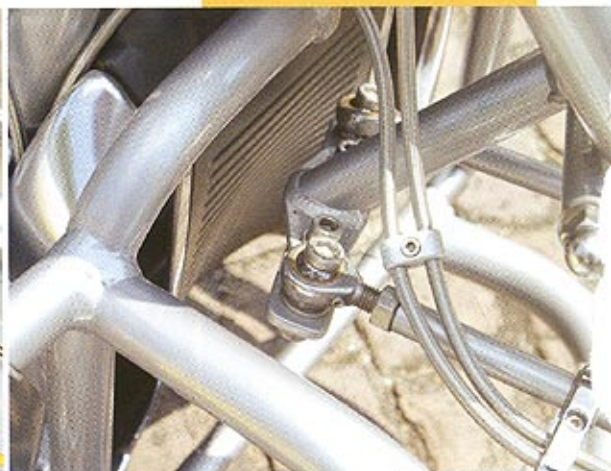
ALLES SAUBER VERLEGT: Bremsleitungen zum Vorderrad
