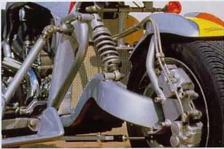
Durch die Abdeckung erhält die geänderte Kyrnos-Lenkung ein eigenständiges Gesicht. Die Haube – wahlweise aus GFK oder Kohlefaser – kann auch auf serienmäßige Kyrnos-Gespänne montiert werden.
