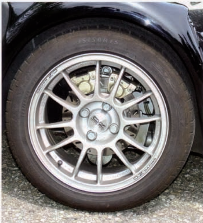
Der zweite Bremssattel deutet meist auf ein Integralbremssystem hin. Nur selten sind die Sättel jeweils mit Hinterrad- und Handbremse gekoppelt.
