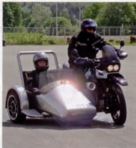
Beim Bremsen verlagert sich der Schwerpunkt nach vorn. Dabei wird deutlich, wie wichtig es ist, dass Beiwagen und Gespann ein aufeinander abgestimmtes Bremssystem haben. Hätte der Beiwagen keine Bremse, würde er das Gespann unweigerlich nach links in den Gegenverkehr schieben.
