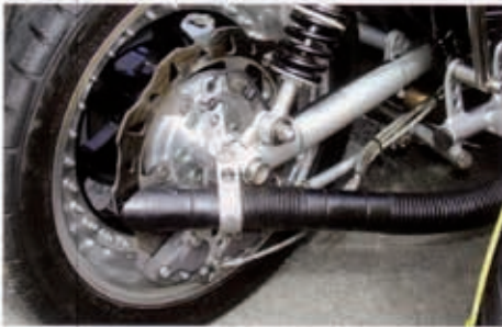
Das doppelte Integralbremssystem erfordert für das Hinterrad eine neue Bremsankerplatte, die zwei Sättel aufnehmen kann.
