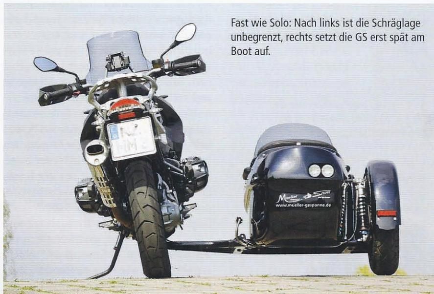
Fast wie Solo: Nach links ist die Schräglage unbegrenzt, rechts setzt die GS erst spät am Boot auf.
