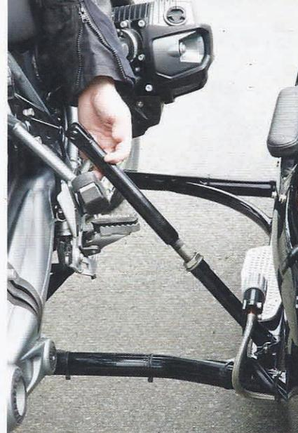
Praktisch: Zum Parken und Rangieren lassen sich Zugmaschine und Boot mittels einer Zusatzstrebe starr fixieren.
