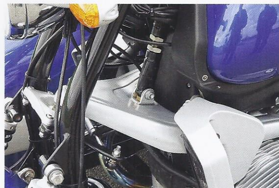
Umfunktioniert: A-Lenker vom Telelever mit starrer Fixierung.
